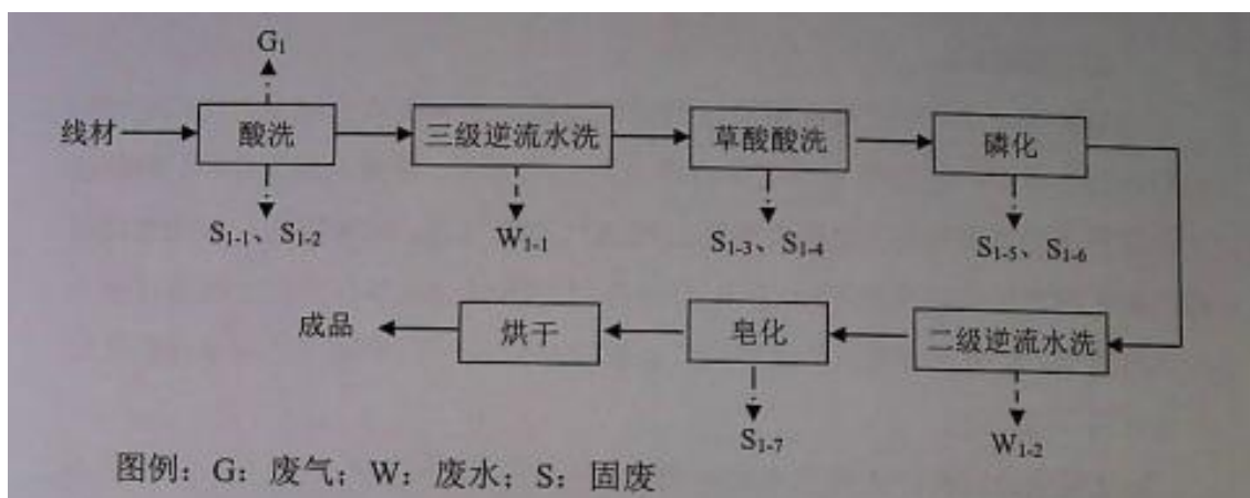
图 4-7 全自动酸洗生产线工艺流程及排污节点图
